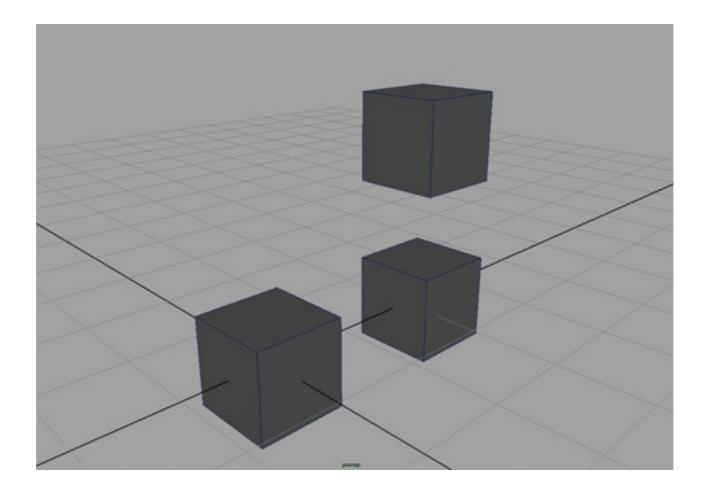
$$\begin{bmatrix} x' \\ y' \\ z' \\ 1 \end{bmatrix} = \begin{bmatrix} 1 & 0 & 0 & t_x \\ 0 & 1 & 0 & t_y \\ 0 & 0 & 1 & t_z \\ 0 & 0 & 0 & 1 \end{bmatrix} \begin{bmatrix} x \\ y \\ z \\ 1 \end{bmatrix}$$
