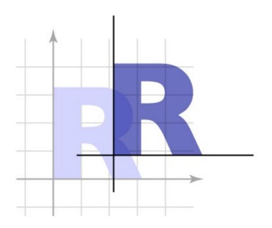
$$\begin{bmatrix} x' \\ y' \\ z' \\ 1 \end{bmatrix} = \begin{bmatrix} 1 & 0 & 0 & t_x \\ 0 & 1 & 0 & t_y \\ 0 & 0 & 1 & t_z \\ 0 & 0 & 0 & 1 \end{bmatrix} \begin{bmatrix} x \\ y \\ z \\ 1 \end{bmatrix}$$
