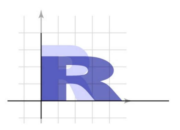
$$\begin{bmatrix} x' \\ y' \\ z' \\ 1 \end{bmatrix} = \begin{bmatrix} s_x & 0 & 0 & 0 \\ 0 & s_y & 0 & 0 \\ 0 & 0 & s_z & 0 \\ 0 & 0 & 0 & 1 \end{bmatrix} \begin{bmatrix} x \\ y \\ z \\ 1 \end{bmatrix}$$
