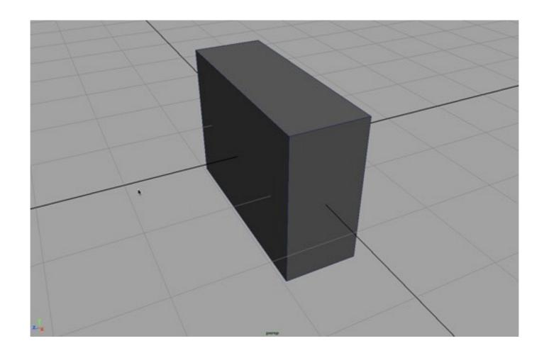
$$\begin{bmatrix} x' \\ y' \\ z' \\ 1 \end{bmatrix} = \begin{bmatrix} s_x & 0 & 0 & 0 \\ 0 & s_y & 0 & 0 \\ 0 & 0 & s_z & 0 \\ 0 & 0 & 0 & 1 \end{bmatrix} \begin{bmatrix} x \\ y \\ z \\ 1 \end{bmatrix}$$
